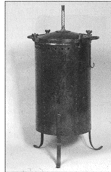
Fig. 5 - Stérilisateur à pression à vapeur pour la salle d'opération aseptisée (Prototype). Fer, Fabricant Lautenschläger, Berlin 1889. Hauteur 108, diamètre 40 cm.
