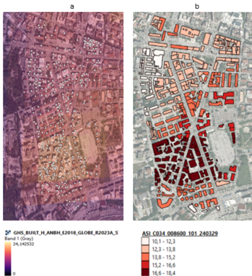
Figura 19. Estrazione dell'altezza dell'edificio in base al centroide riposizionato con ASIR e assegnazione del poligono
