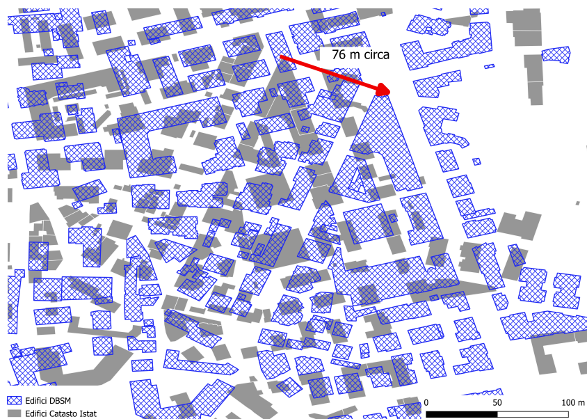
Figura 14. Sovrapposizione del Dbsn (IGM) con il prodotto del georiferimento iniziale del Catasto effettuato da Istat
