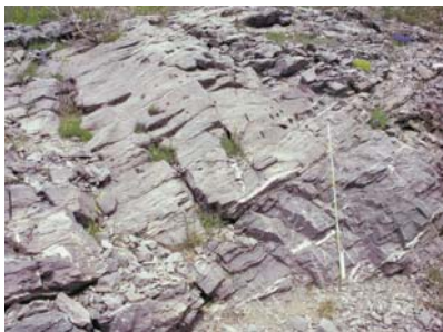
Fig. 5 Ammasso roccioso di tipo A caratterizzato da prevalente componente calcarea - The type A formation is characterized by a prevailing limestone content
