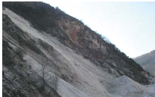
Fig. 14 - Estrazione del materiale al piede del ravaneto - Quarrying of the toe of a quarry dump
