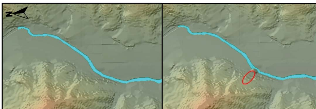
Fig. 10 - Screenshot della situazione appena dopo la fine del movimento franoso (evidenziato in rosso). Si nota chiaramente come i sedimenti mobilitati dalla frana abbiano interferito con il corso d'acqua - Screenshot of the situation immediately after the end of mass movement (highlighted by the red ellipse). You can note clearly the interference between the mobilized sediments and the watercourse
