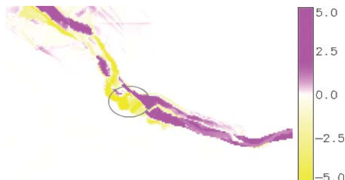
Fig. 13 - Confronto tra la situazione immediatamente dopo la fine del movimento franoso e la situazione a 4 mesi dalla fine dell'evento. I valori riportati in legenda sono espressi in metri
