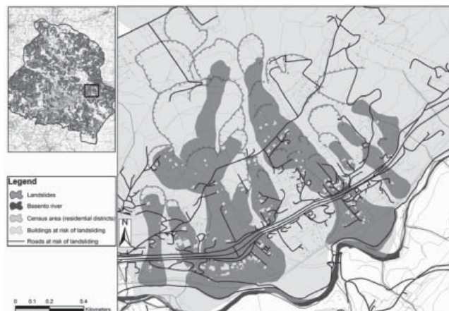
Fig. 6 - Data overmapping tra la città di Potenza e gli elementi a rischio di frana (PASCALE et alii, 2010, mod.) - Potenza city near Basento data overmapping with areas and elements at risk of landsliding (PASCALE et alii, 2010, mod.)
