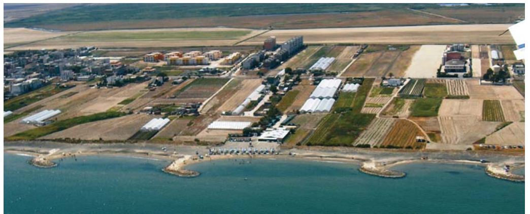
Fig. 12 - Distanze disuguali tra pennelli per la presenza di stabilimenti balneari - Uneven distances between groynes due to the presence of bathing establishments
