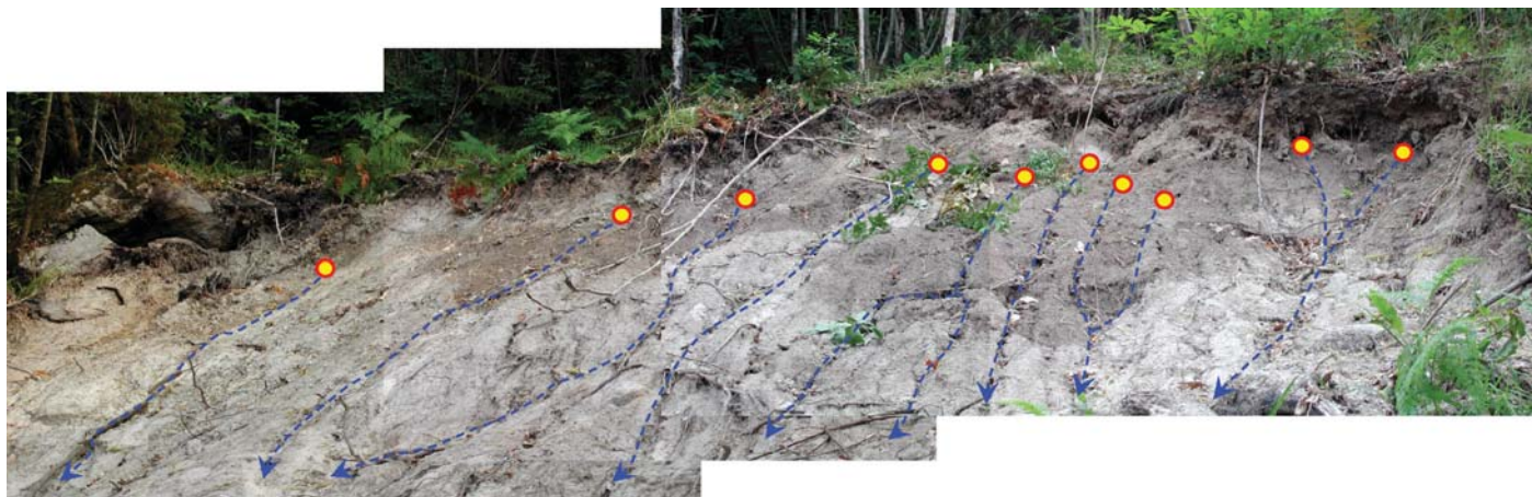
Fig. 8 - Tracce di erosione per rivoli rilevate nella scarpata principale della frana 5 (linee tratteggiate blu). I punti sorgente (cerchi rossi) sono localizzati al contatto tra gli orizzonti A + B + C1 e l'orizzonte C2 - Rill erosion traces surveyed in the main scarp of the fifth landslide (dashed blue lines). The source points (red circles) are located at the contact between A + B + C1 and C2 horizons
