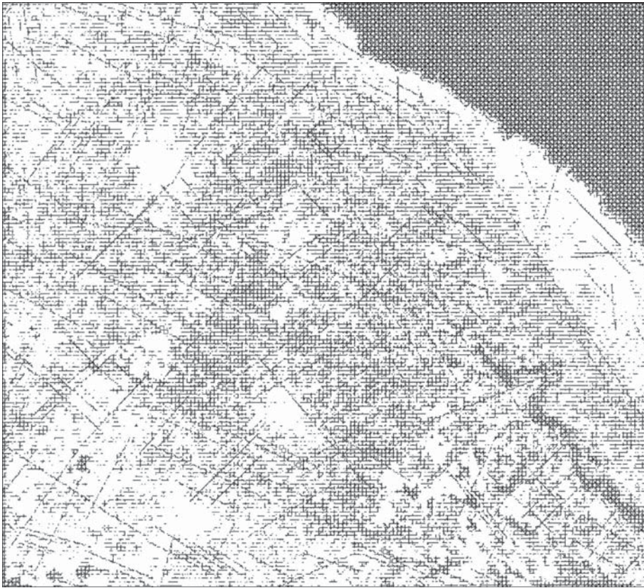
Fig. 4 - Polilinee ottenute dall'analisi dello scattergramma che evidenzia gli allineamenti caratterizzati da elevata umidità e contrasto termico - Polylines obtained from analysis of the scattergram, which shows lineaments with high moisture and thermal contrast
