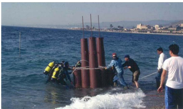
Fig. 7 - Esperimento RC1992: il modello della piattaforma offshore in fase di varo - Experiment RC 1992: the launching of the offshore platform model
