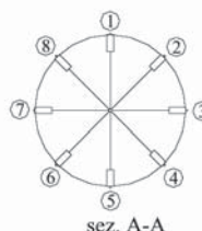
Fig. 8 - Esperimento RC 1993: disposizione dei trasduttori di pressione lungo la superficie del tunnel - Experiment RC 1993: disposition of the pressure transducers along the surface of the tunnel
