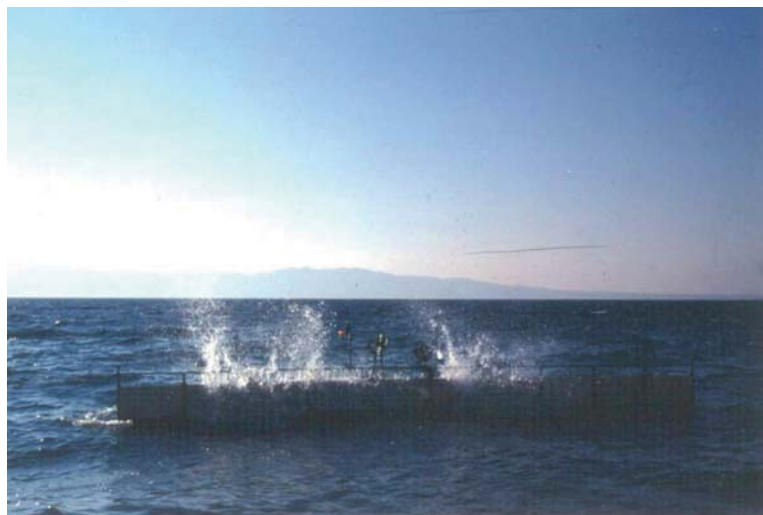
Fig. 5 - Esperimento RC1991: parete in mare soggetta all'azione di una mareggiata di forte intensità - Experiment RC1991: wall in the sea subject to the action of a sea storm of strong intensity
