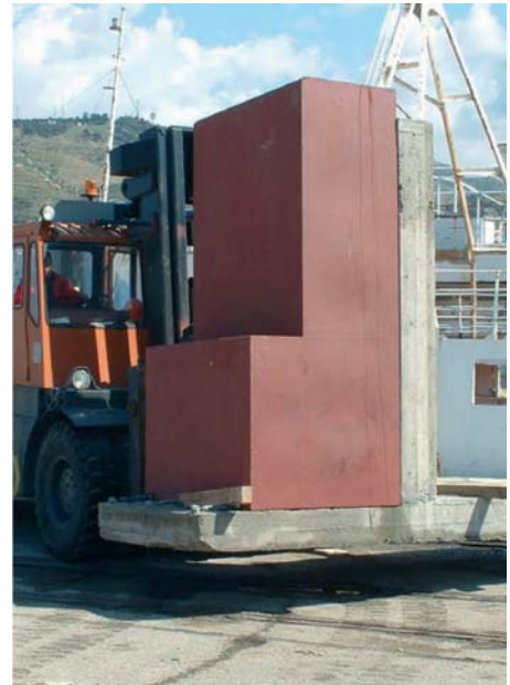
Fig. 18 - Uno dei nove moduli costituenti la diga assorbente dell'esperimento RC2005 - One of the nine modules constituting the absorbing breakwater of the experiment RC 2005
