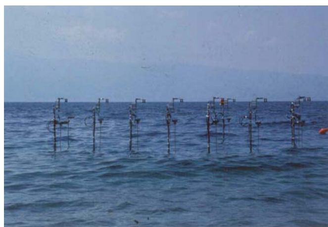
Fig. 3 - Esperimento RC1990: i tralicci che reggevano gli strumenti per la misura dell'elevazione d'onda (sonde ultrasoniche) e del carico di pressione (trasduttore di pressione) - Experiment RC1990: the piles supporting the gauges for measurement of wave elevation (ultrasonic probes) and pressure fluctuations (pressure transducers)
