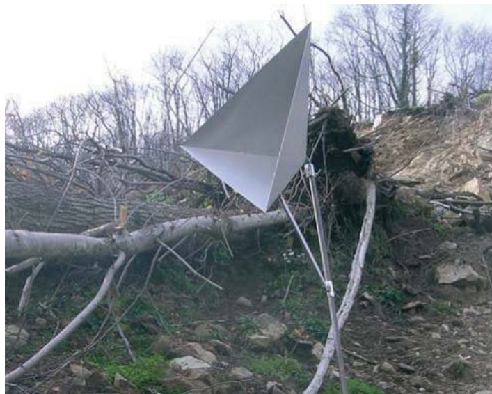
Fig. 11 - Corner reflector utilizzato per la georeferenziazione della mappa radar - Corner reflector used for georeferencing the radar map
