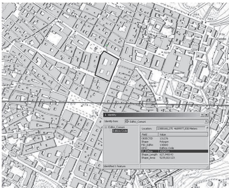
Figura 2. Il layer poligonale della banca dati vettoriale della Carta Tecnica alla scala 1:5.000 Foglio n. 359 – Sezione 1:5.000 n. 012 e n. 051. L'insieme di poligoni ha varie descrizioni, tra cui «edificio civile». In nero è stato selezionato un poligono per il quale, nella finestra di pop-up, è mostrato il dettaglio informativo.
