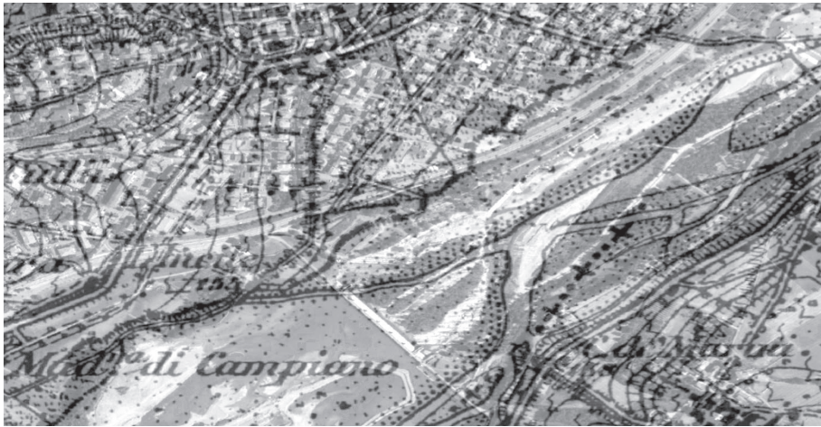
Fig. 2 – Tavoletta IGM “Sassuolo” alla scala 1:25.000 del 1884 georeferita su ortofoto del 2012. Si nota come l'antico alveo del fiume, delimitato dalle arginature e dai pennelli, sia in parte occupato da infrastrutture fra le quali spicca la moderna Strada Provinciale 486.
